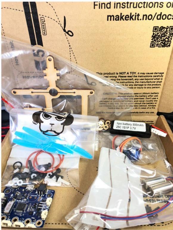
零件內容: 紙皮、透明密實袋、木製框架(結構)、扇葉 x4、螺絲套件連橡筋、micro:bit 擴充板、電池、伺服馬達(servo)、馬達 x2
