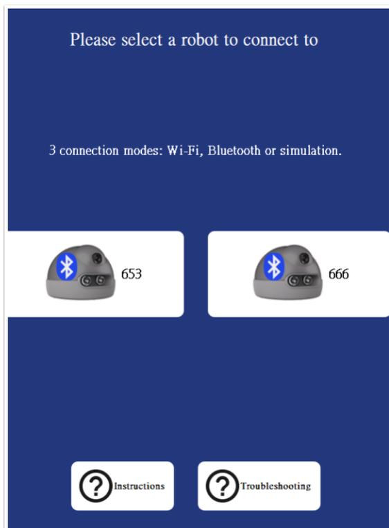
AlphaAI 的連接並不複雜，但由於它的 software 跟 firmware 更新比較頻繁，因此需定期以 WiFi 連接 AlphaAI 從而更新機器人的 firmware version，舊版本並不能進行連接，你必須更新好 AlphaAI 機器人的 firmware 才能進行連接及機械學習等行為。
