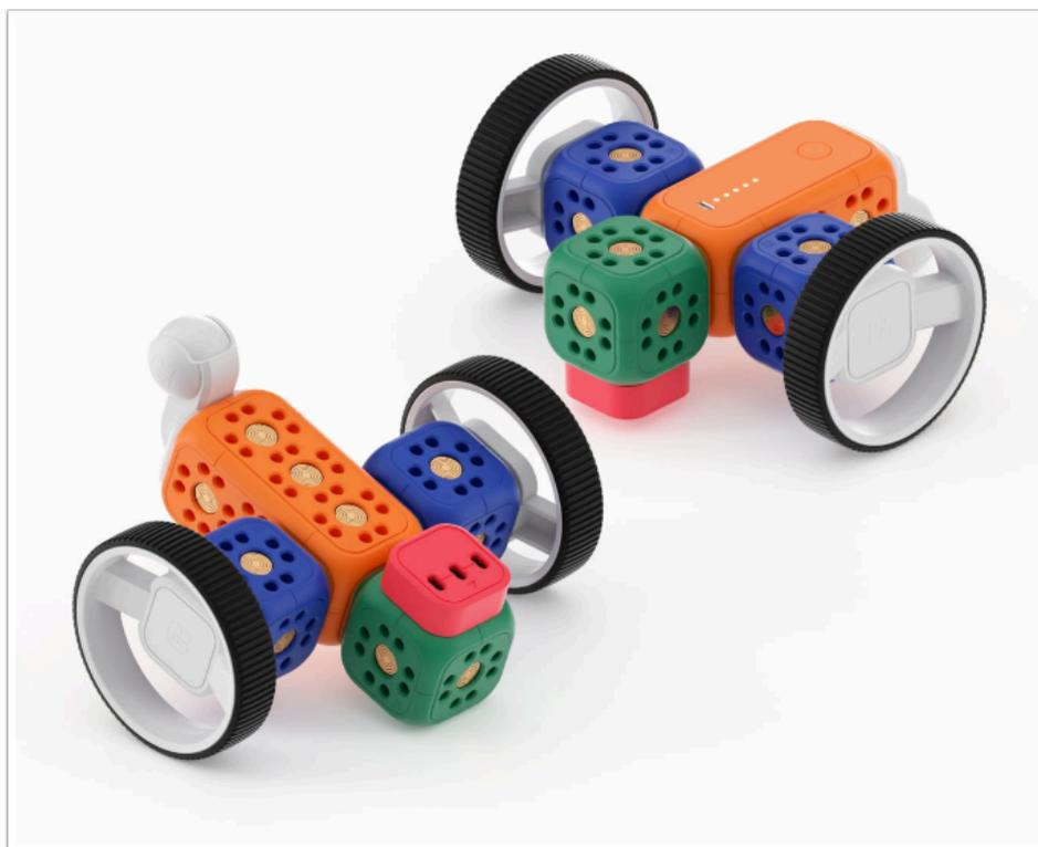
按圖砌好Robo循線小車。它可以偵查底下的黑線並自動作出反應。
