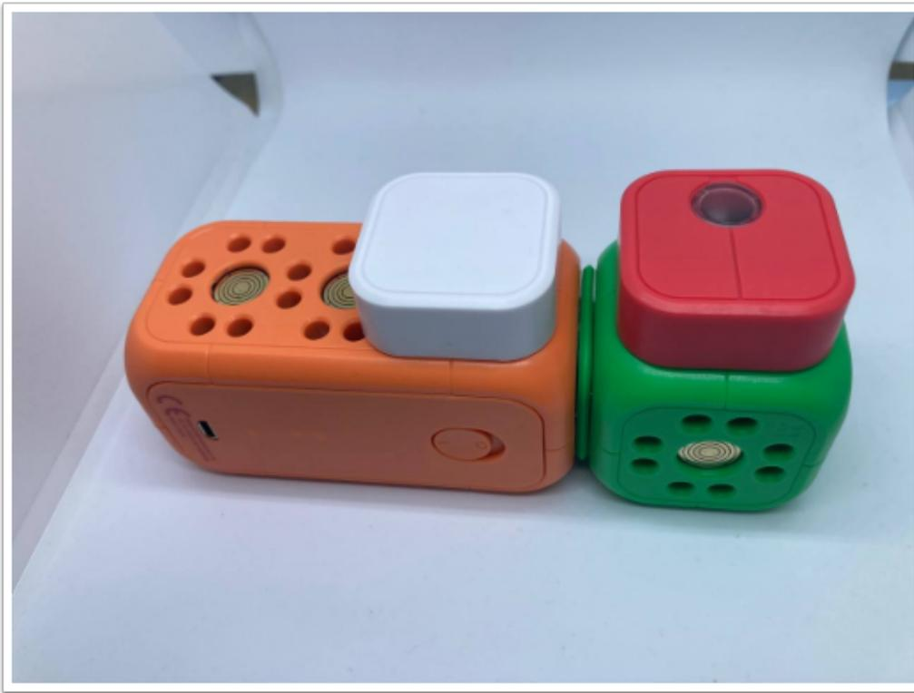
我們先做一個簡單的光強度測試器，如上圖只需要將RGB燈、光感應器、按鈕插在一起即可。同時，我們可以預備一枝電筒作測試。如沒有，用手機即可。新舊版本的 Robo 操作上並無分別。
