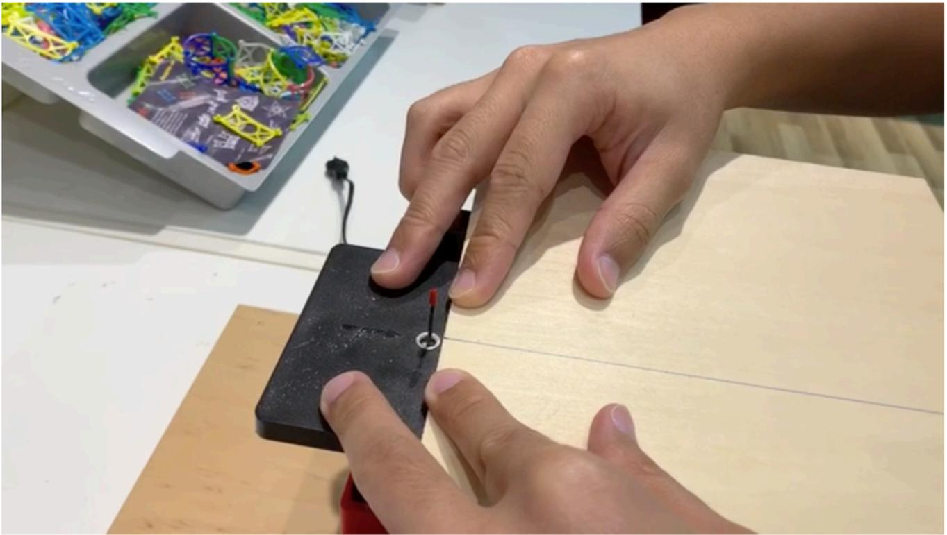
3. 開啟線鋸機，並用兩隻手按緊物料，別讓物料上下移動。然後把物料慢慢向前推，直到切割完成為止。如果要切割的是彎線，在向前推的同時亦可微微轉向，沿著線慢慢推進。
