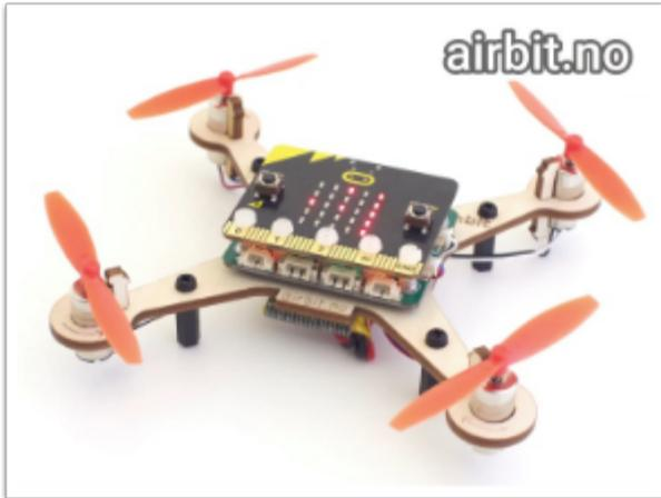
Air:bit是款以micro:bit為核心的無人機套件，使用者可以將各種零件組合成四軸無人飛行機，並透過編程、App或另一隻micro:bit以radio來控制它的飛行。
